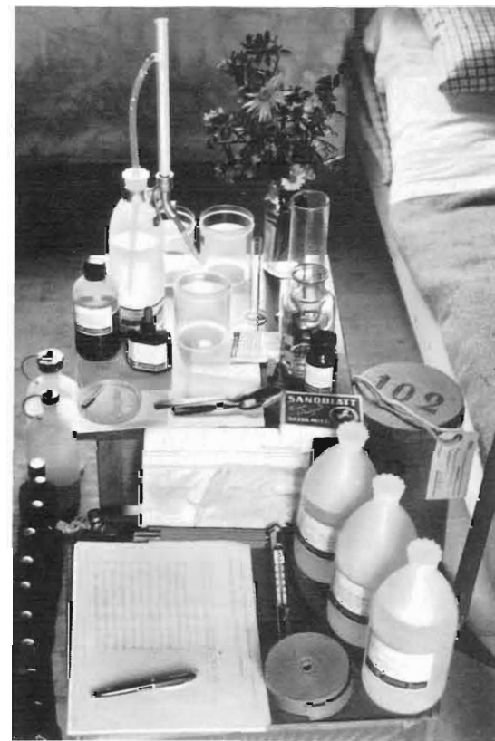
Abb. 22 Feldmässiges Labor zur Ermittlung der Wasserhärte (Titationsmethode für Karbonat- und Gesamthärte) Aufn. Verfasser
