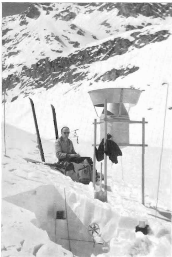
Abb. 20 Piano dei Canali. Niederschlags-Totalisator. Gewichtsmässige Bestimmung des Schnee-Wasserwertes zur allfälligen Korrektur der Totalisator-Werte (Windverwehung!) Aufn. Verfasser
